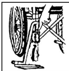
10. Для снятия подножек нажмите на фиксатор для снятия подножек с фиксации.
