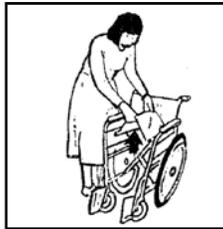
2. Для складывания кресла поднимите опоры подножек, а затем потяните сиденье вверх.
